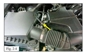
(d) Squeeze the clip and unplug the mass airflow sensor (Fig. 2-4).
